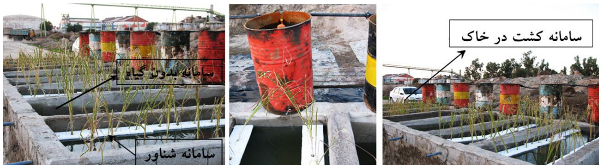
شکل ۳. نمایی از سامانه‌های تالاب مصنوعی مورد استفاده در تحقیق
